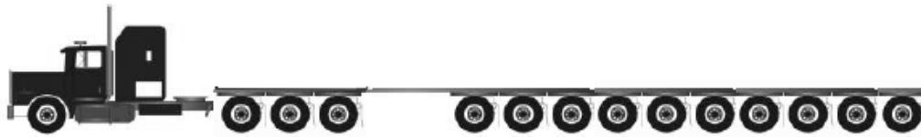
Figura 3: Configuración esquemática del vehículo CCE2
